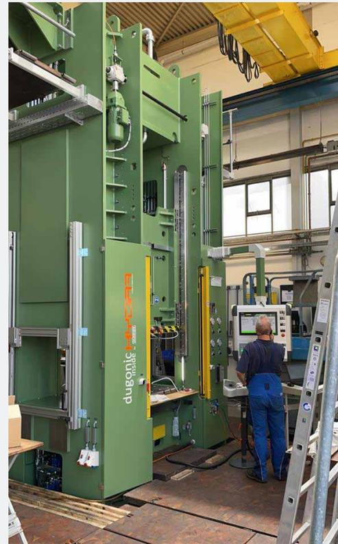
2021 wurde die Dunks 250 t Tiefziehpresse installiert. Die moderne Parameterverwaltung ermöglicht einfacheres und schnelleres Rüsten. Das Tiefziehen erfolgt feinfühler und formt Dünobleche exakter um, trotz 50 Tonnen mehr Presskraft. Anbindungen für zukünftige Automatisierungen sind enthalten. Beste Sicherheitstechnik schützt die Mitarbeiter/innen.
